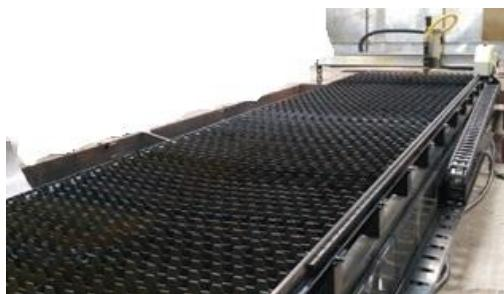
Предназначена для качественного плазменного раскроя листового металла с рабочей зоной 6 м x 1.5 м, толщиной до 0.5 до 100 мм (зависит от источника резки).
