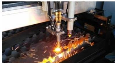
Данную модель возможно дооснастить дополнительным газо-кислородным оборудованием, включающим газовый резак, электронику управления, управляющие клапана, редуктора, огнепреградительные клапаны и т.д..
