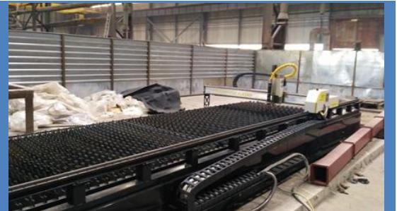
Стол обшият со всех сторон. Имеются специальные люки. В зависимости от комплектации станка подготовка к вентиляции либо отсутствует (бюджетный вариант) или выполнена система вытяжки в зоне реза, что многократно повышает производительность вытяжки. При обустройстве системы вентиляции оборудование должно иметь производительность не менее 6000 м.куб./час.
