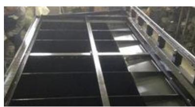
Многозонная система дымоудаления. Стол станка разбит на несколько зон. При движении портала специальные клапана открывают воздушные заслонки только там, где работает резак. В остальных зонах заслонки закрыты. Данная конструкция позволяет более продуктивно использовать вытяжную систему.
